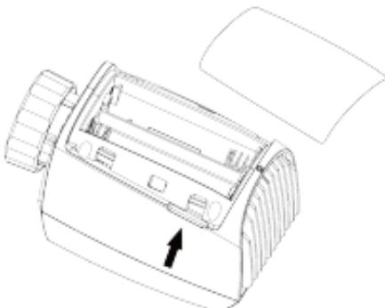
Životnosť nových alkalických batérií je zhruba 1,5 roka. Symbol batérií (**bAt**) na displeji znamená, že batérie treba vymeniť. Po vybratí vybitých batérií cca 1 minútu počkajte, kým vložíte nové. Toto zariadenie nepodporuje používanie dobíjacích batérií.
