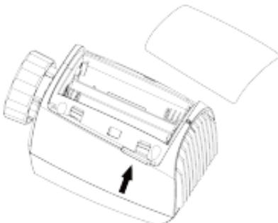
Wytrzymałość nowych baterii alkalicznych porusza się w granicach 1,5 roku. Symbol baterii (bateria) na wyświetlaczu oznacza, że baterię trzeba wymienić. Po tym, co wyjmiesz wyladowane baterie, odczekaj mniej więcej 1 minutę zanim włożysz nowe. Niniejsze Urządzenie nie wspiera użycia akumulatorów do wielokrotnego ładowania.
