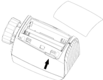
Die Lebensdauer der neuen Alkalibatterien beträgt etwa 1,5 Jahre. Das Symbol der Batterien (bAt) auf dem Display bedeutet, dass die Batterien zu ersetzen sind. Nach dem Herausnehmen der ausgeladenen Batterien warten Sie etwa 1 Minute, bevor Sie neue einlegen. Dieses Gerät unterstützt die Nutzung der wiederaufladbaren Batterien.
